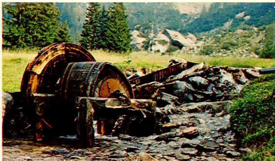
Interessante esempio di zangola idraulica, per la fabbricazione del burro
