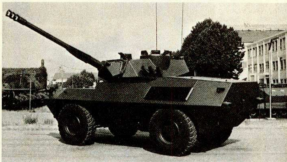
Versione sperimentale dell'autoblindo Fiat OTO Melara 6616 armata col cannone Cockerill Mk III da 90/36
