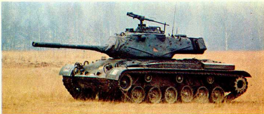
Carro armato M-47. Risalente alla guerra di Corea è meno superato di quanto si creda. Il principale difetto, un'autonomia di soli 130 km., può essere rimediato sostituendo il motore a benzina con un Diesel. Fornirlo agli alpini sarebbe una soluzione economica, ma accettabile, sebbene non ottimale
