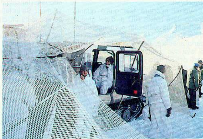
Norvegia: nelle lande della Lapponia il mezzo più redditizio per spostarsi sulla neve è il cingolato «Hagglunds BV - 206», che qui vediamo adibito a posto comando e mimetizzato con le reti di mascheramento bianche
