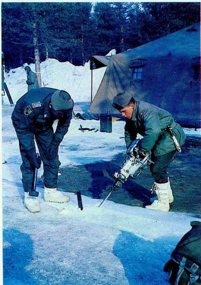
Norvegia: a 30° gradi sottozero l'unico modo di togliere i picchetti delle tende dal ghiaccio è usare il martello pneumatico
